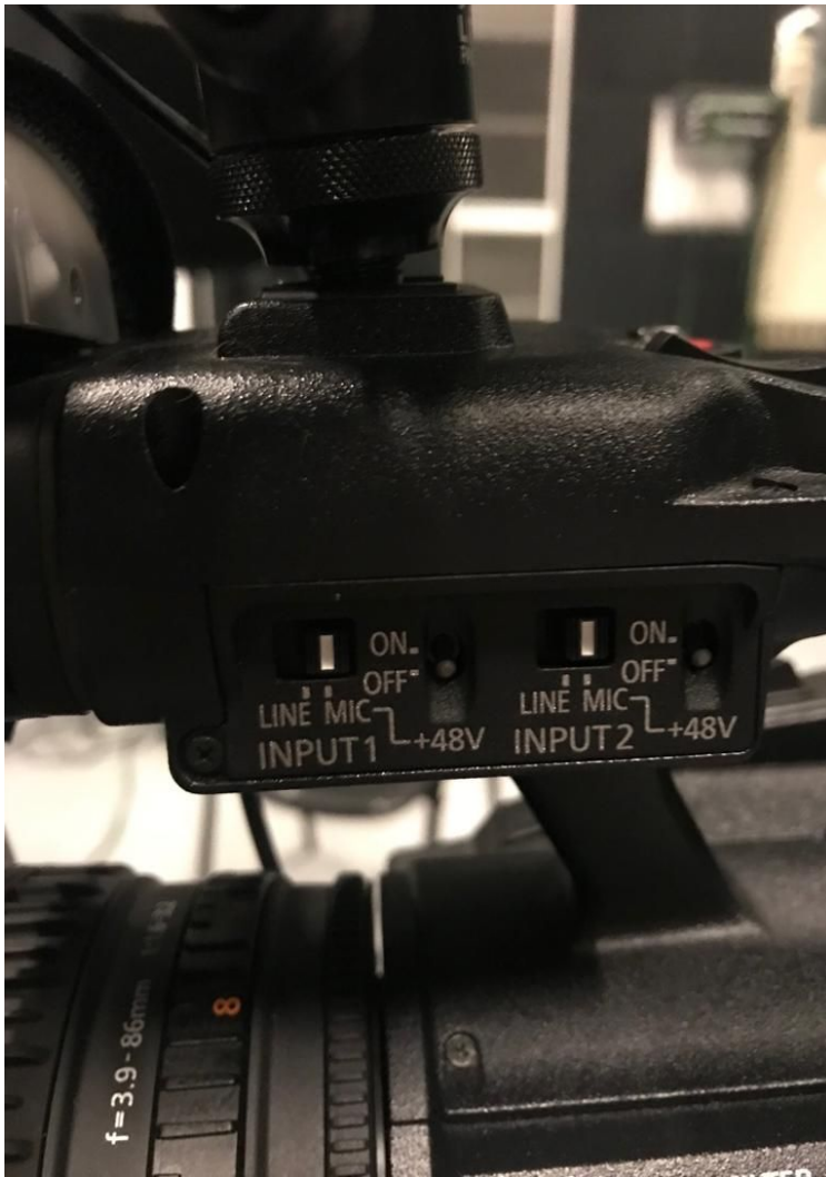
Foto 3. Perillas con raya blanca en MIC, las otras hacia abajo, en OFF. Es el phantom y en este caso no lo necesitamos. Seteo para ambas cámaras.
