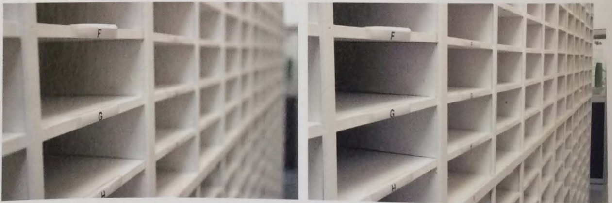
Figura 3.12 Efecto práctico de la profundidad de campo. En estos dos ejemplos el objetivo está enfocado sobre el mismo punto. (La versión de la derecha precisa un tiempo de exposición mayor para compensar la menor luminosidad de la imagen, porque la apertura del objetivo es menor y, por tanto, deja pasar menos luz.) Izquierda f/2,8; derecha f/16.
