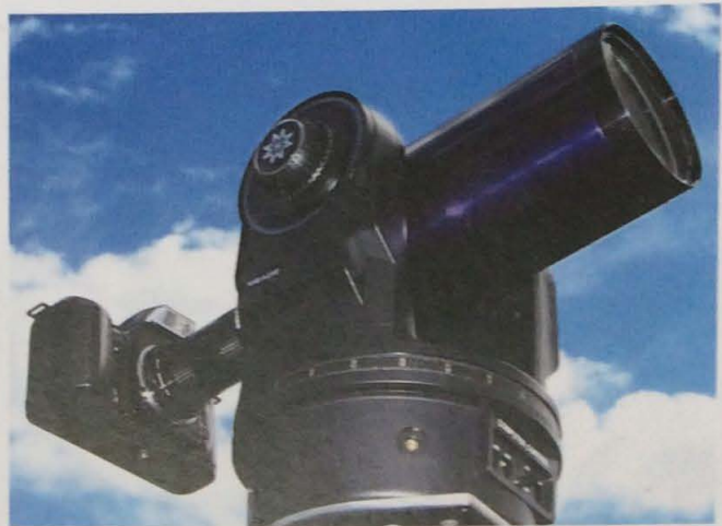
Figura 5.20 La montura T se utiliza para acoplar cámaras de 35 mm a un telescopio astronómico.
