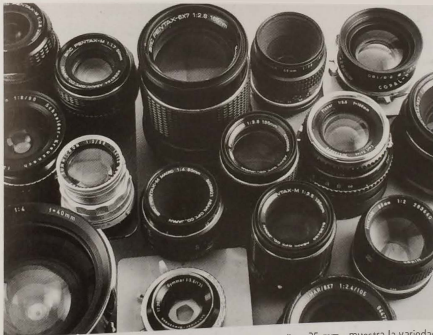
Figura 3.9 Este grupo de objetivos —para cámaras de gran formato, formato medio y 35 mm— muestra la variedad de formas en que aparece la información relativa a la apertura, longitud focal y número de referencia.
