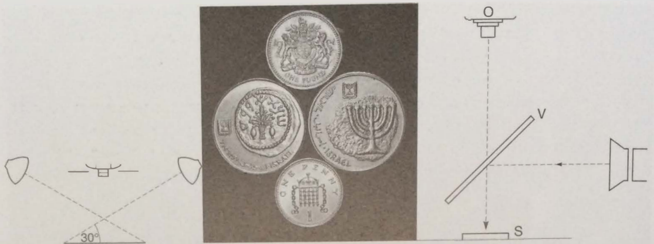
Figura 7.28 Esquemas de iluminación plana. Arriba: esquema para trabajos de reproducción. Las luces están dispuestas con un ángulo de 30° respecto a la superficie del sujeto, a una distancia de como mínimo el doble de la anchura del sujeto, y dirigidas hacia el borde más alejado. Una cartulina negra cerca de la cámara bloquea los reflejos. Centro: monedas fotografiadas a través de (V) una lámina delgada de vidrio a 45° (véase diagrama, derecha). El objetivo de la cámara (O) sigue el mismo eje que la luz de la lámpara que ilumina el sujeto (S).
